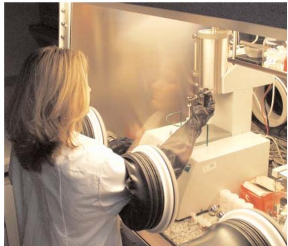
Abb. 3: Vollständig in einen Argon-Handschuhkasten integriertes Thermoanalyse-System (DTA/TG).
